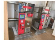
オゾン発生装置
