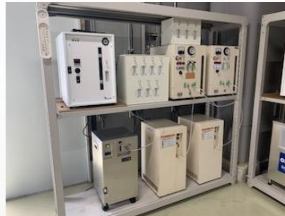
オゾン発生装置
